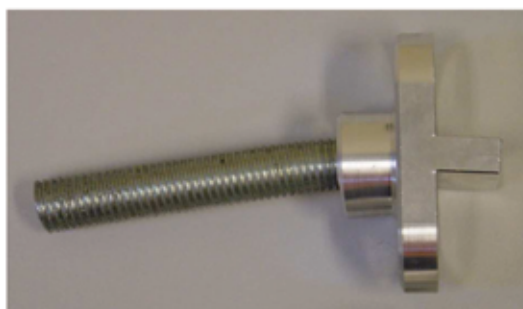
Figura 23. Sostegno a due vie deformato dalla prova a taglio.
