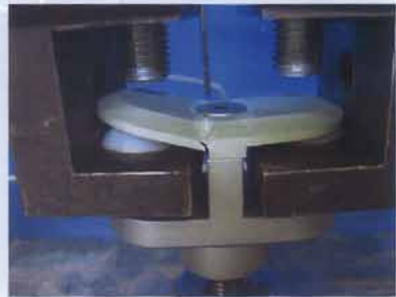
Fotografia di un sistema di fissaggio al termine della prova.
