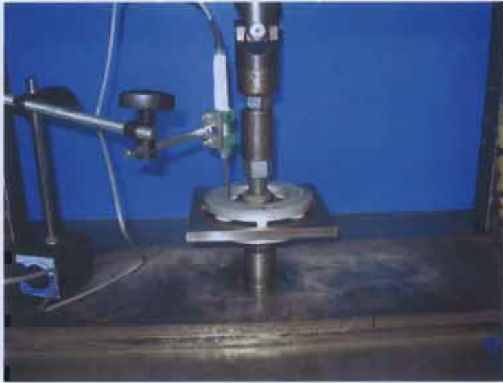
Fotografia di un sistema di fissaggio durante la prova.
